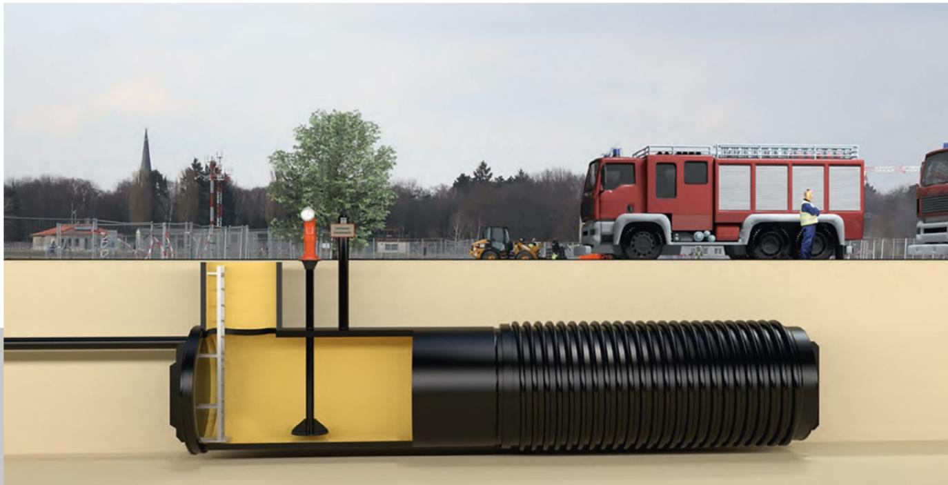
Standard-Varianten für die typischen Löschwasservorhaltemengen nach DWA W 405.
